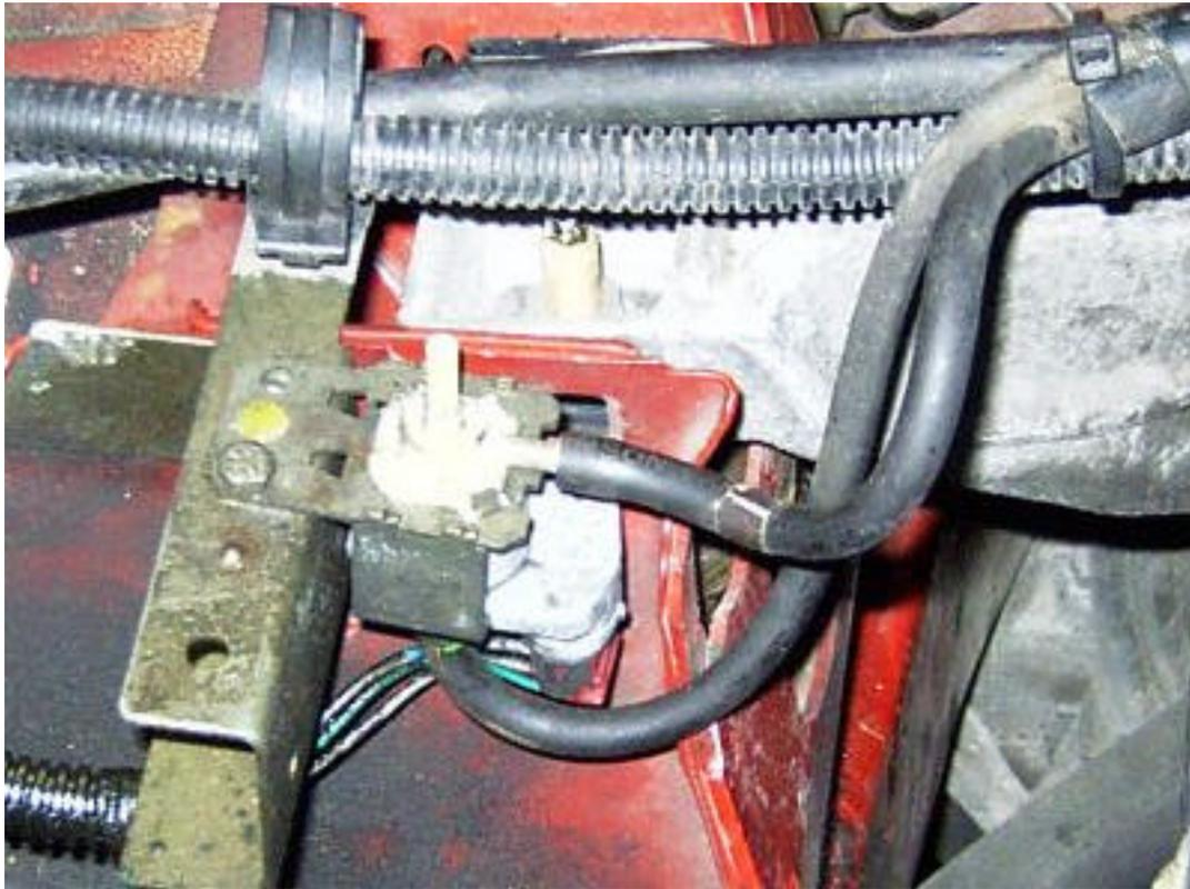
Der untere Schlauch führt zum Ansaugtrakt, der, der seitlich abgeht, zur Unterdruckdose. Ein Fehler im Bereich der Unterdruckdose kann die Ursache für extremen Kraftstoffverbrauch oder eine sehr schlechte Gasannahme, bis hin zum plötzlichen Ausgehen des Motors sein.
